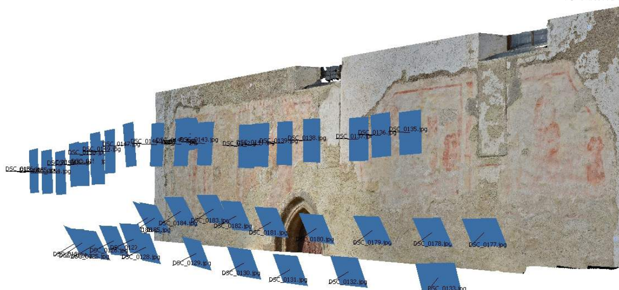
5. Schéma spôsobu snímkovania a výsledná podoba 3D modelu snímanej časti fasády. Autor: M. Marčíš, 2016.
